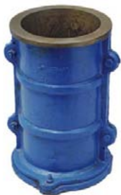
(قالب نمونه برداری استوانه ای)
