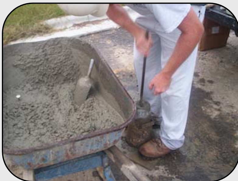
(متراکم کردن بتن با ضربه میله تراکم)
